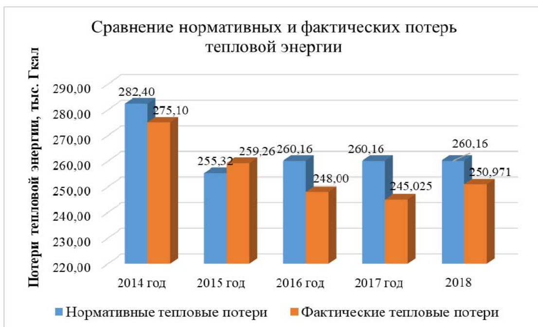
Рисунок 19. Сравнение нормативных и фактических потерь тепловой энергии на тепловых сетях
