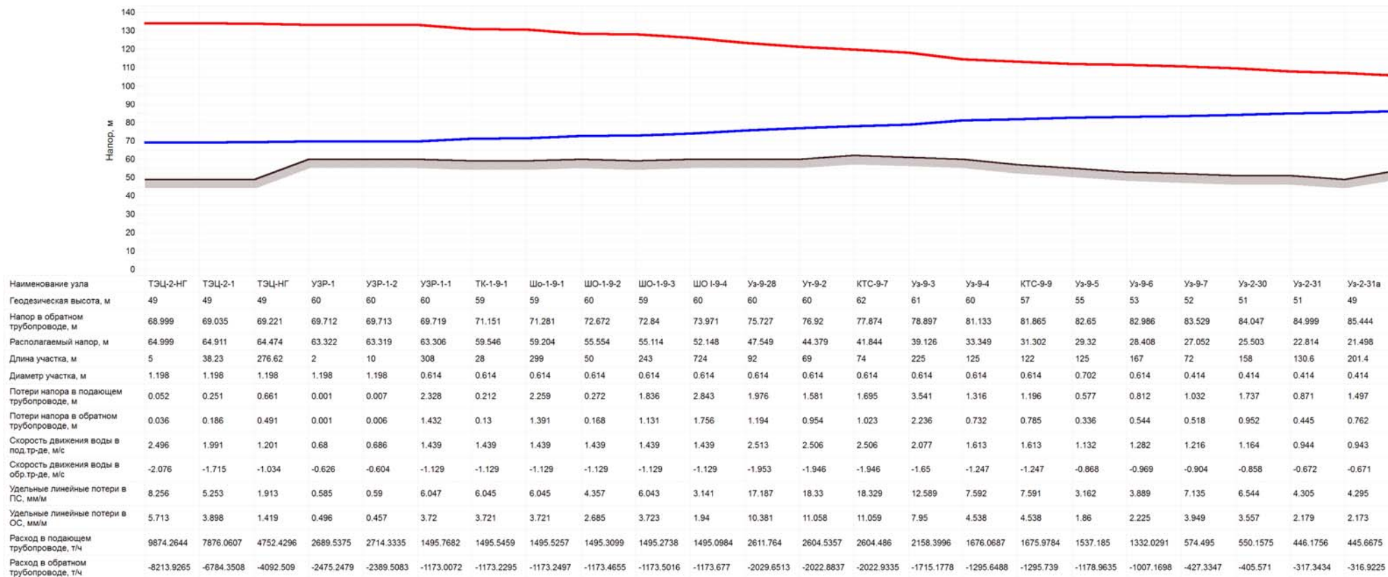
Рисунок 10. Пьезометрический график (пример построения в программном комплексе Zulu)
