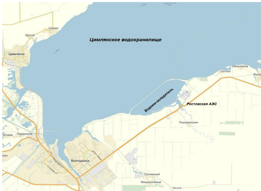
Рисунок 6.2.5.4. Размещение промплощадки и водоема-охладителя Ростовской АЭС
