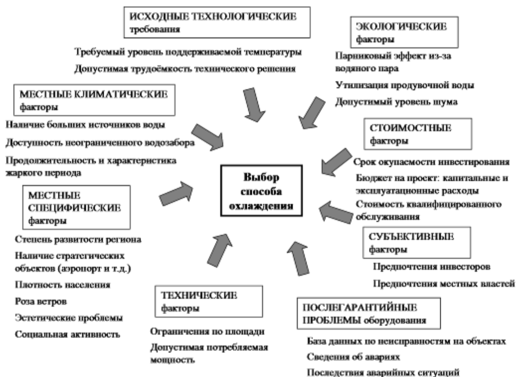
Рисунок 4.2.2.1 – Факторы, влияющие на выбор системы технического охлаждения
